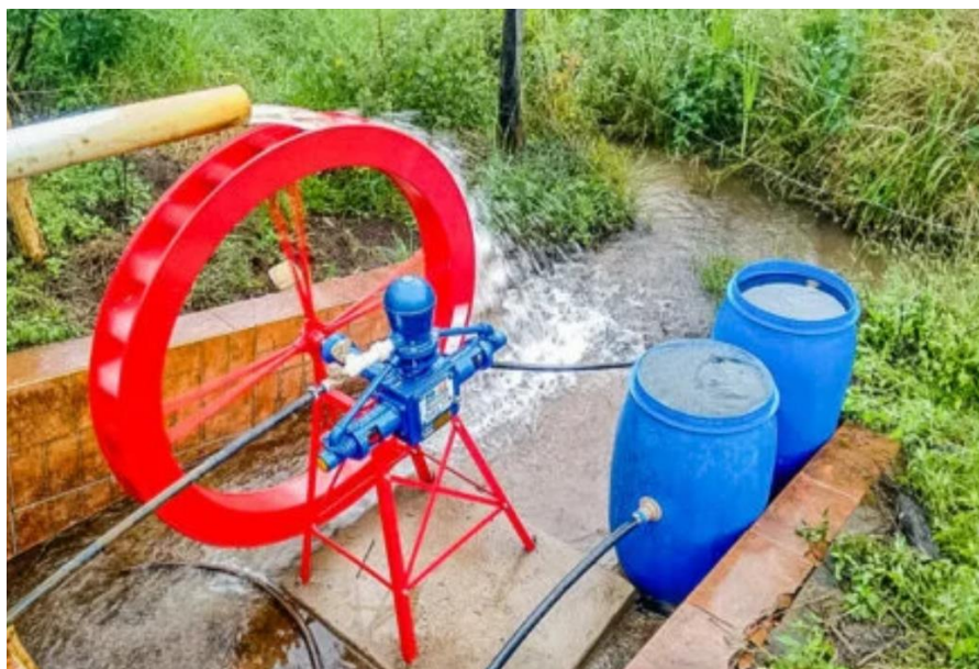
Figura 123. Esquema de sucção e recalque por sistema de roda d'água. Fonte: SANTOS, 2018. Disponível em: https://blog.meritocomercial.com.br/bombear-agua-de-baixo-para-cima/ . Acesso: 01/05/2023.
