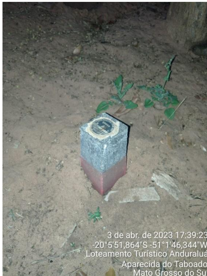
Figura 36 - Marco georreferenciado indicando cota máxima dos reservatórios do complexo hidrelétrico de ilha solteira. Fonte: visita técnica, 2023.
